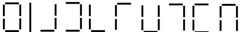
6-сегментный формат на основе 7-сегментного формата без среднего горизонтального сегмента (б), и формирование цифровых знаков 6-сегментного формата.
