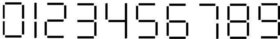
7-сегментный формат (б) и на его основе цифровые знаки арабского происхождения (в).
