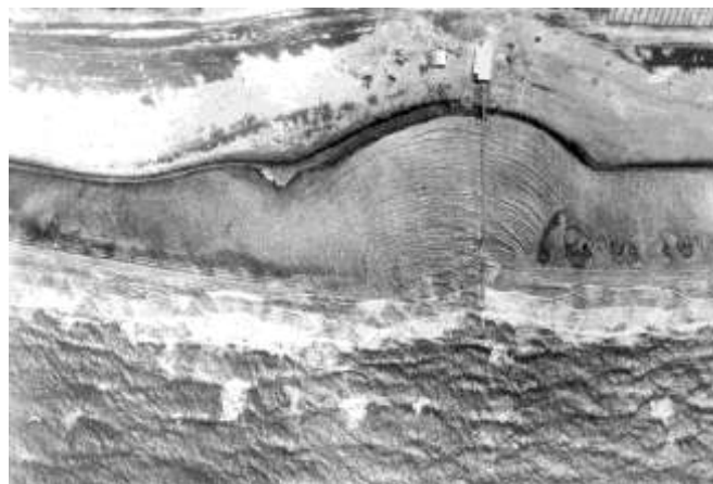
Рис. 7.6. Дифференциация волны при проходе ее через узкий пролив в каменной гряде, едва возвышающейся над поверхностью моря (аэрофотоплан).
